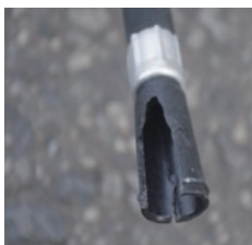
× ノズルの破損
