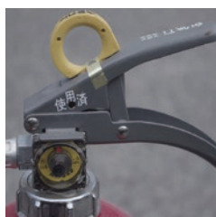
× 表示装置の脱落
