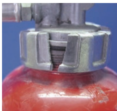
× キャップの破損
