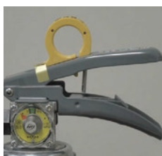
× レバー支えの脱落
