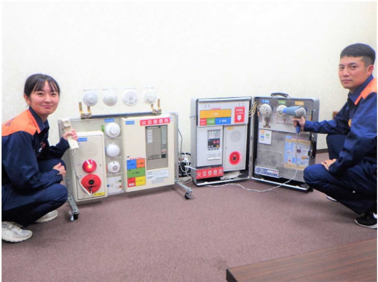
職員教養資材として自動火災報知設備のデモ機を作成
