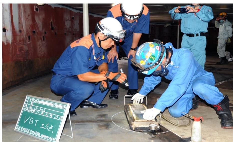
関西国際空港給油センター 屋外タンク貯蔵所の検査
