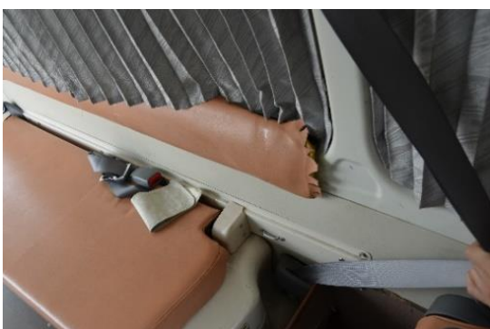
後部の折り畳み式座席シートに破れあり
